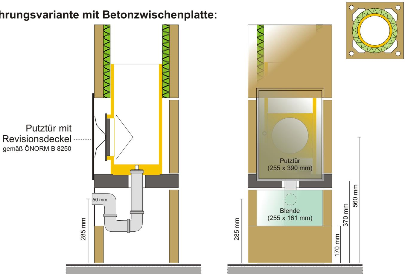
**Anmerkung:** Durch Setzen eines weiteren leeren Mantelsteins am Rohboden kann hier die Höhe der Putztür auf einfache Weise vergrößert werden.
