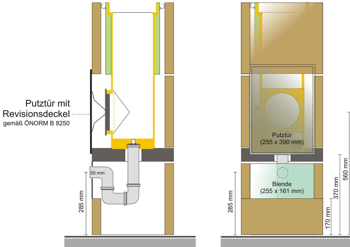
**Anmerkung:** Durch Setzen eines weiteren leeren Mantelsteins am Rohboden kann die Höhe der Putztür auf einfache Weise vergrößert werden.
